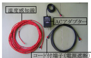
〔制御装置の外部接続機器〕
