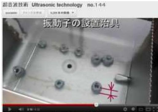
振動子に対して液面高さが最適化するように
