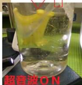
超音波洗浄器内のホース内を流れるマイクロバブルが 超音波刺激を受けます
