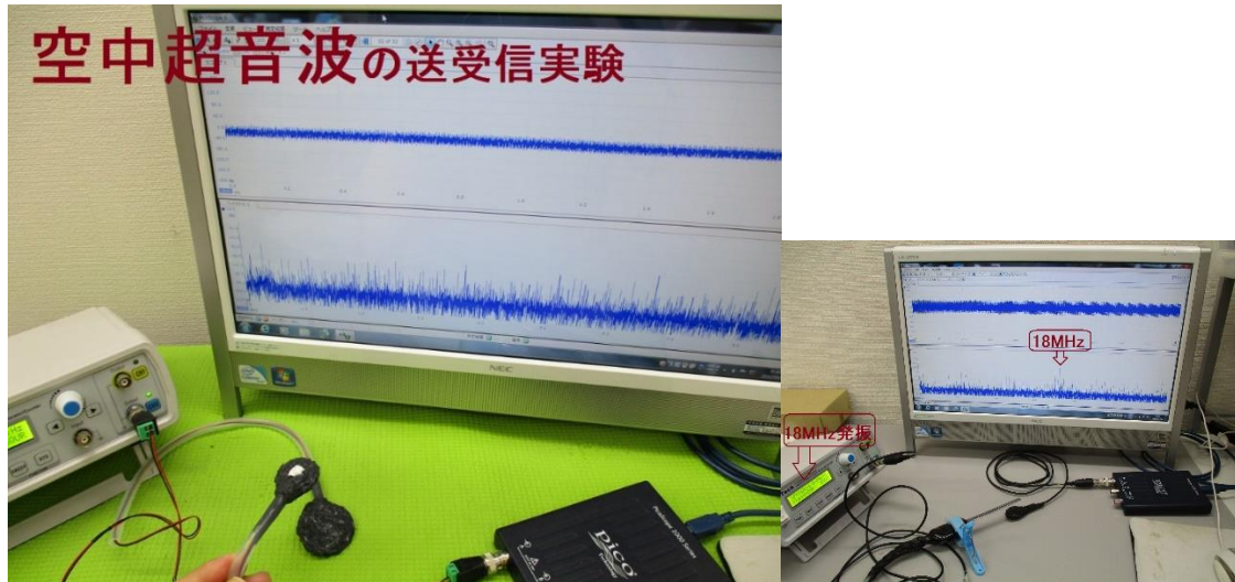
写真1 空中超音波伝搬（発振 500kHz 5V）
