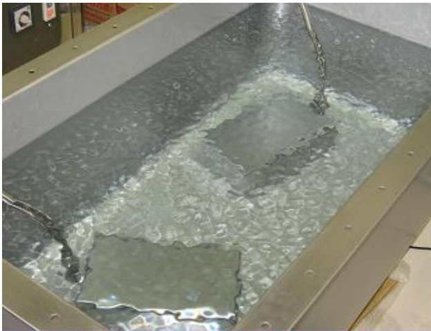
均一な超音波伝搬状態 28kHz+72kHz 550W
