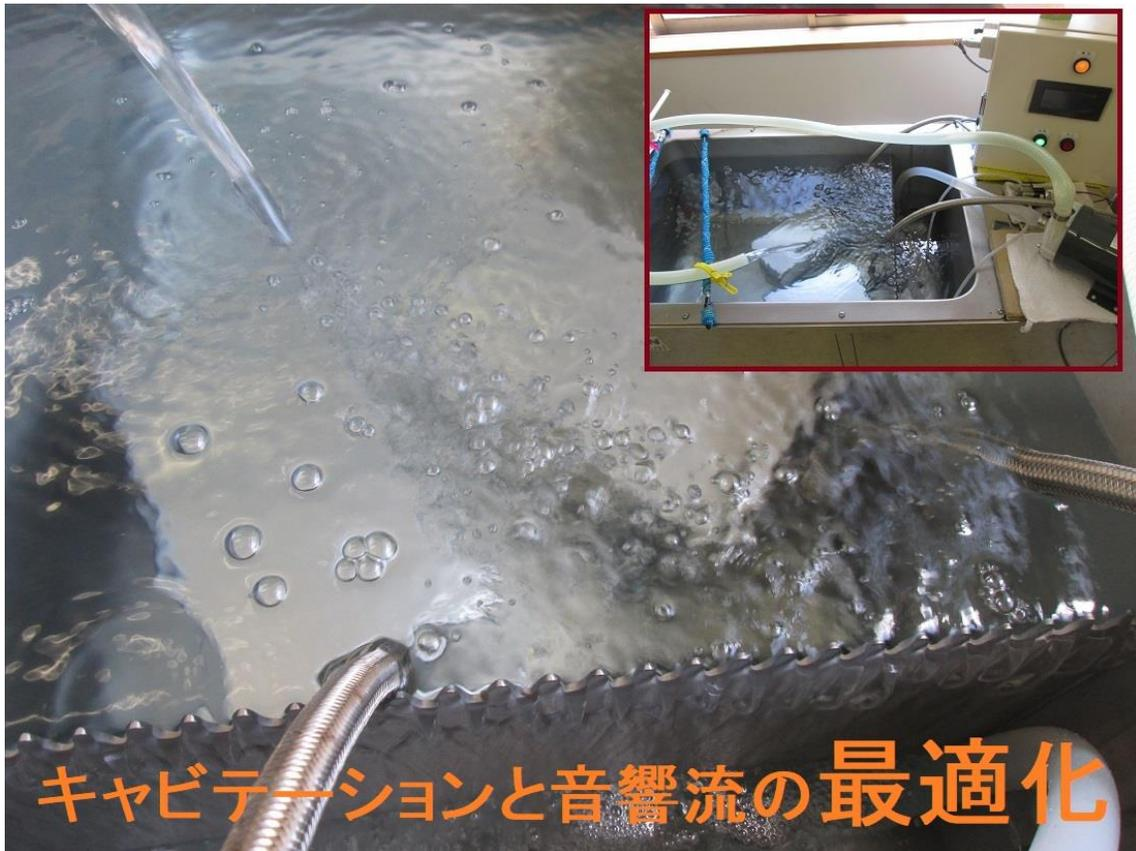
脱気マイクロバブル発生液循環装置
