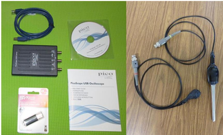
写真1：超音波テスターNA (オシロスコープ 100MHz タイプ)
