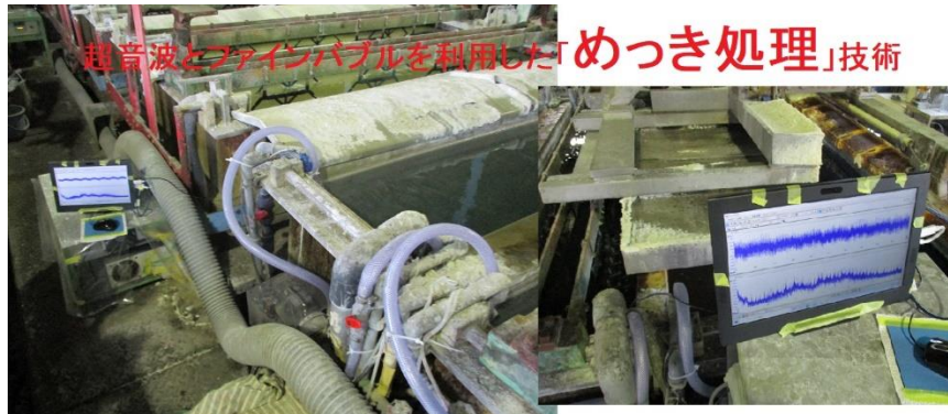
写真6 超音波とファインバブルによる超音波洗浄
