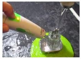
応用 流水と ガラス容器と 超音波による 精密洗浄方法
