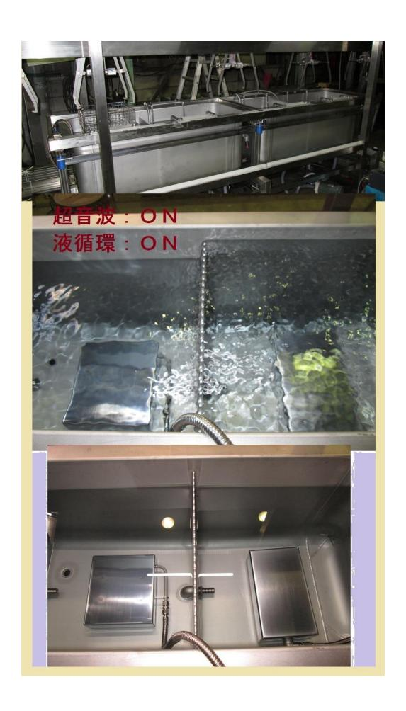
超音波と液循環による音響流の制御
