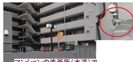
マンションの洗面所(水道)で超音波プローブを取り付けて計測
