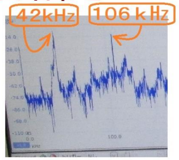
42kHzの超音波洗浄器と 106kHzのファンクションジェネレータの組み合わせ
