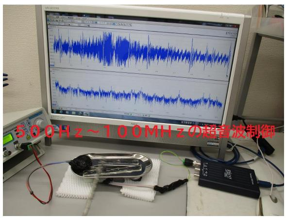
各種対象(水槽、振動子、プローブ、治具、対象物・・・)について 基本的な音響特性(応答特性、伝搬特性)を解析確認することで、 目的の超音波伝搬状態を実現する、発振制御が可能になります。
