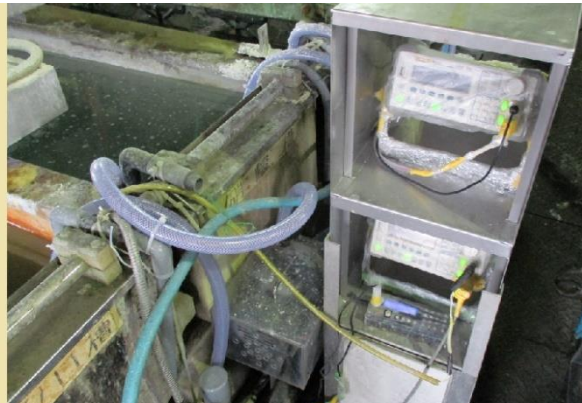
超音波発振システム(1MHz、20MHz)を利用した実験
