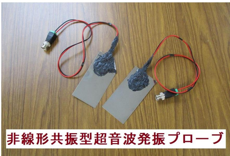
**非線形共振型超音波発振プローブ**
