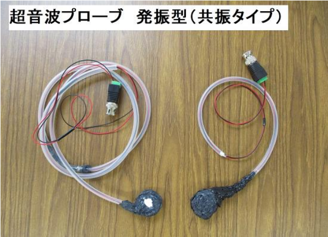
超音波プローブ 発振型(共振タイプ、非線形タイプ)
