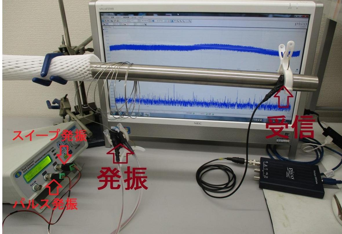
超音波システム（音圧測定解析、発振制御）
