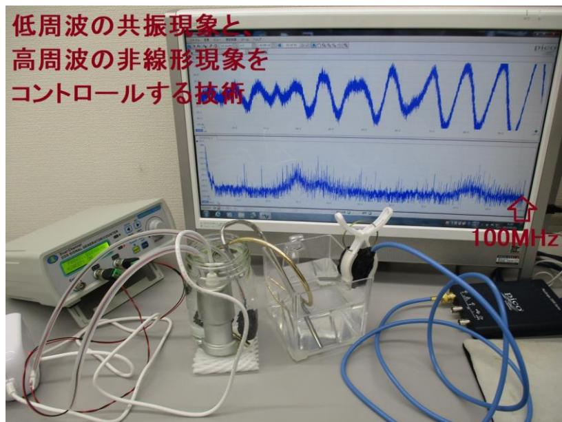
ポイント1：液体に伝搬する超音波と弾性体に伝搬する超音波
