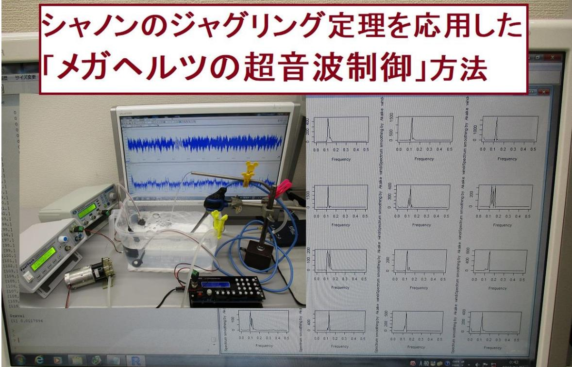
超音波の音圧測定解析システム「超音波テスターNA」
