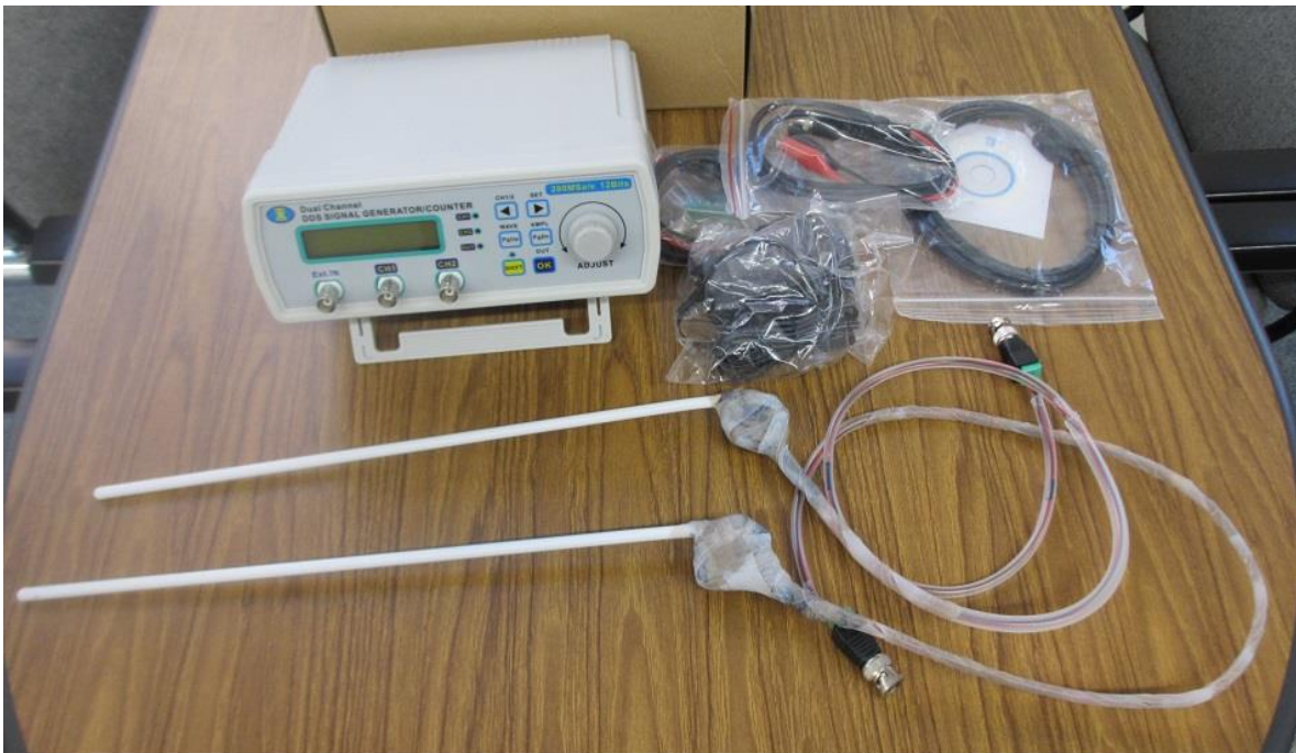
テフロン棒(鉄心入り)の音響特性を利用した 超音波発振制御システム
