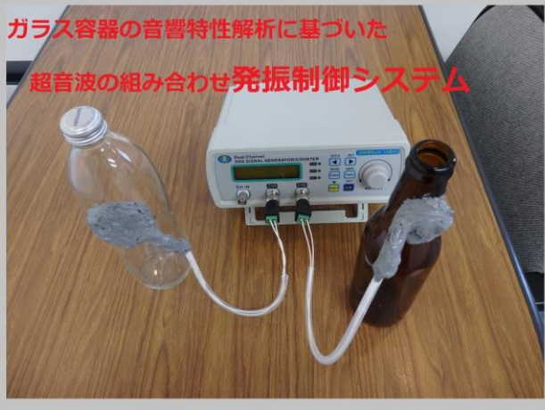
ステンレスパイプを利用した 超音波発振プローブ
