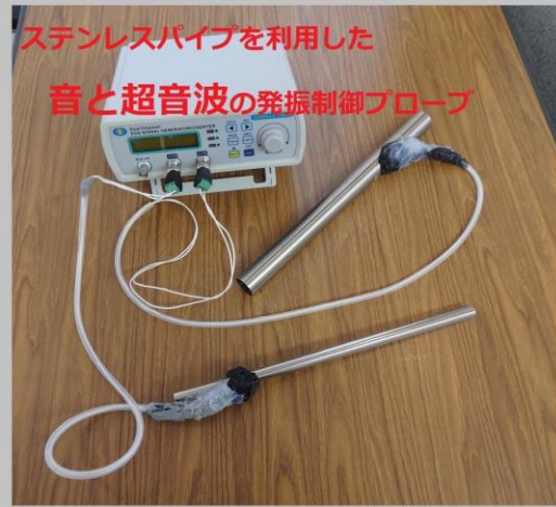
ステンレスパイプを利用した 超音波発振プローブ
