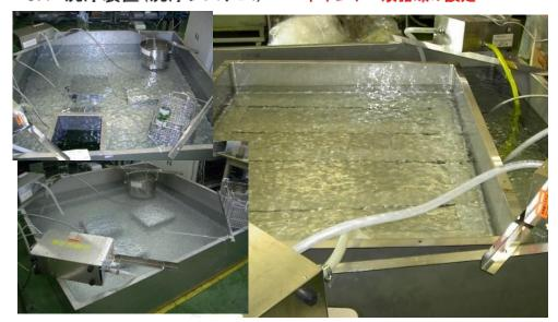
水槽サイズ: 2000\*2000\*500mm 超音波 38kHz 600W(1台 写真右) 超音波 100kHz 400W(1台 写真左下)
