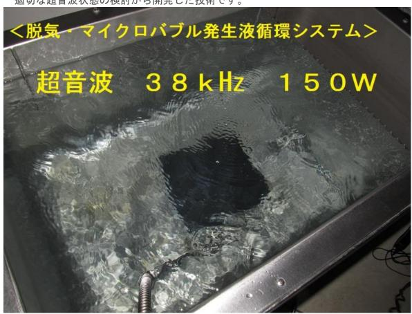
出力10Wから出力1800Wまでの超音波システムによる実施例で、 有効な結果が得られています。
