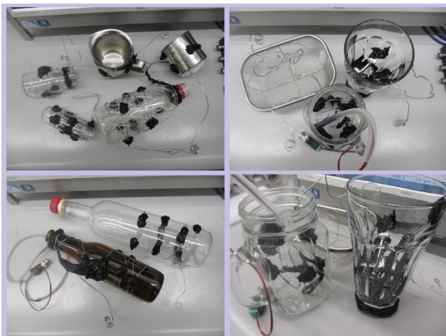
ステンレス線を利用した超音波伝搬部材
