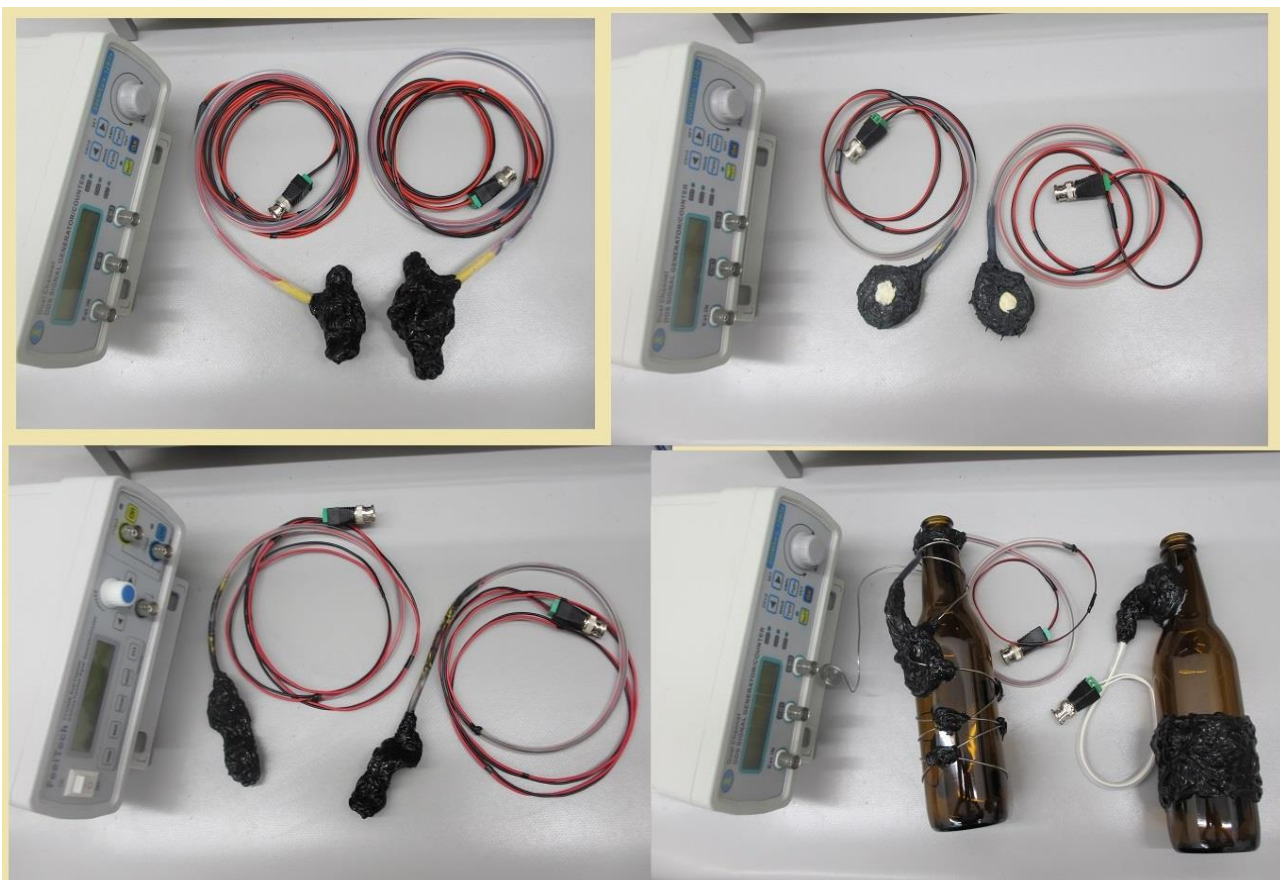
超音波発振システム (20MHz)
