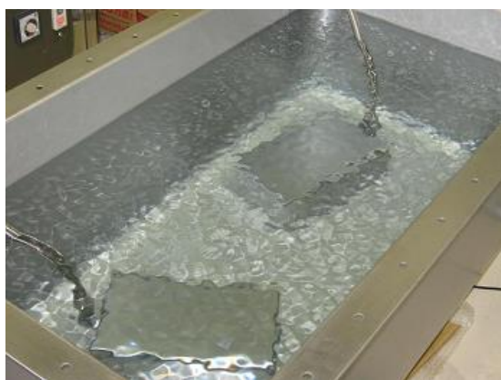
72 kHz 単独照射 (300W 超音波 出力 45%)
