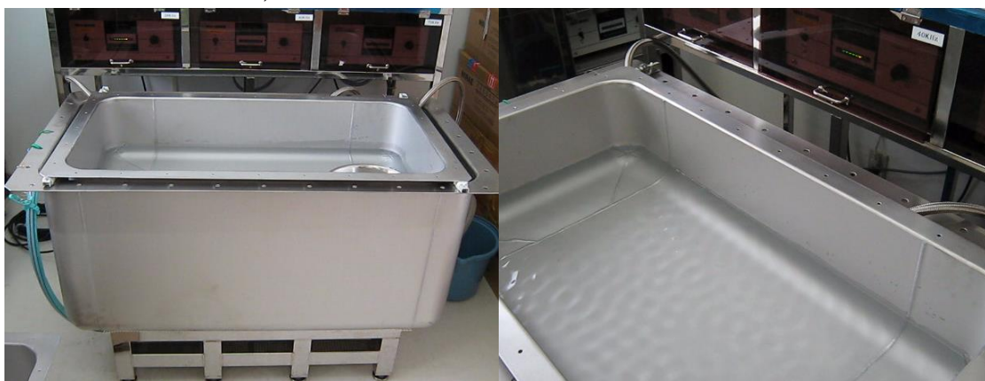
間接水槽 2 寸法 (内寸) : W880×D450×H200mm 注 : 外形寸法は W,D 内寸+板厚+80mm
