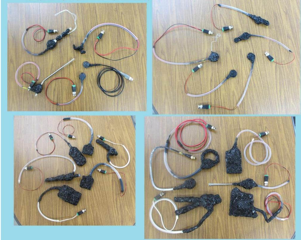
超音波プローブ（発振型、測定型、共振型、非線形型）の製造技術
