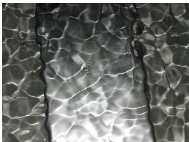
超音波システムでの実験状態 (28kHz 170W + 72kHz 200W 水槽:105 * 55 * 45cm)
