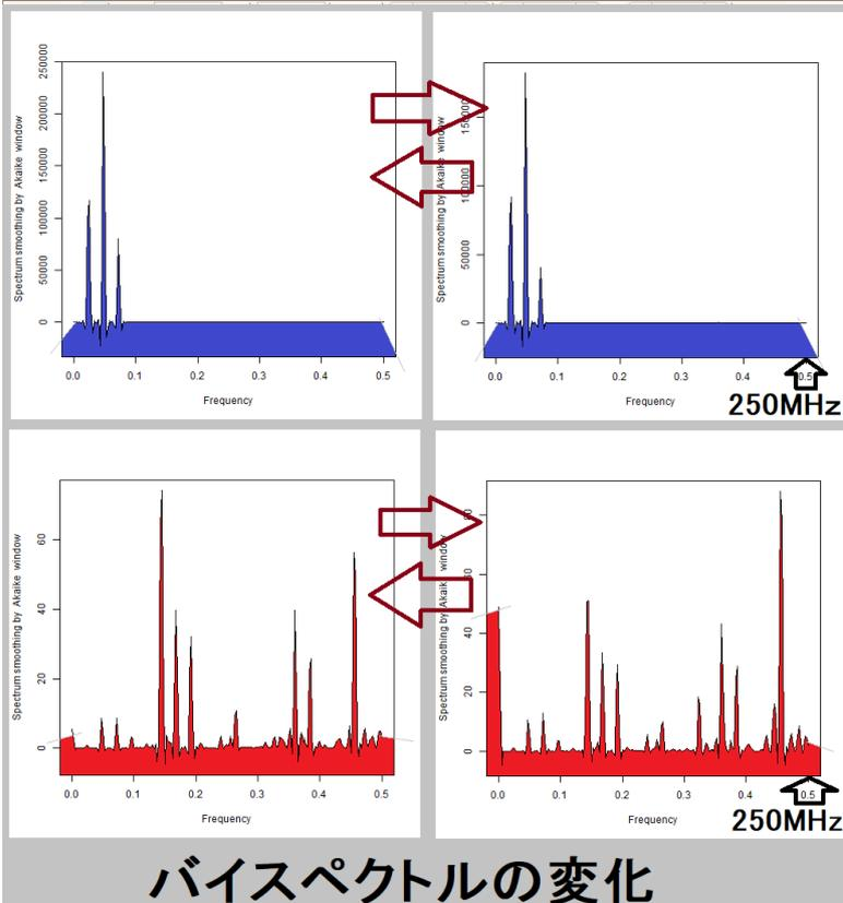
グラフ赤：10MHz以下の発振でも200MHz以上のバイスペクトルが値を持ちます。従って、600MHz以上の超音波伝搬状態が実現しています
