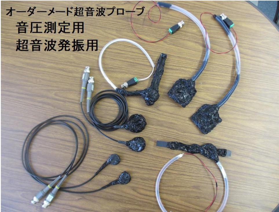
超音波発振制御プローブ
