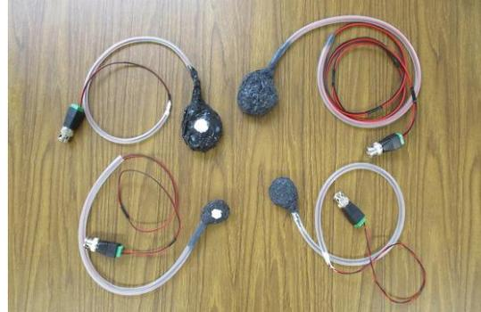
超音波プローブ 発振型(共振タイプ)
