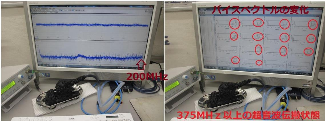
説明：ステンレス容器に、LCP（液晶樹脂）を取り付けたプローブで発振
