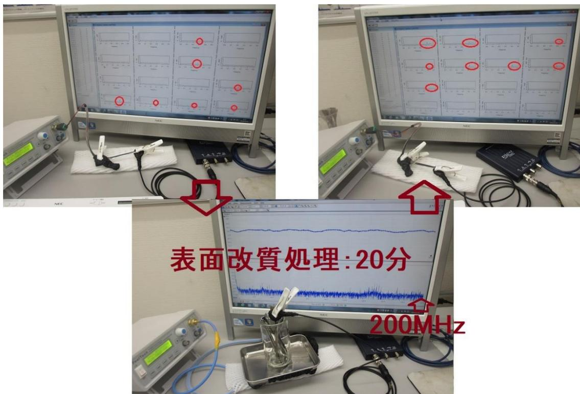
説明：600MHz以上の超音波伝搬による、金属部品の表面改質処理
