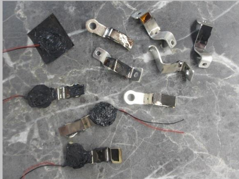
ポリイミドフィルムに鉄めっきを行った部材を利用した超音波プローブ
