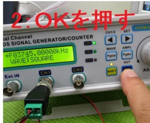
OUTが点灯していると、CH1、CH2の両方が出力しています
