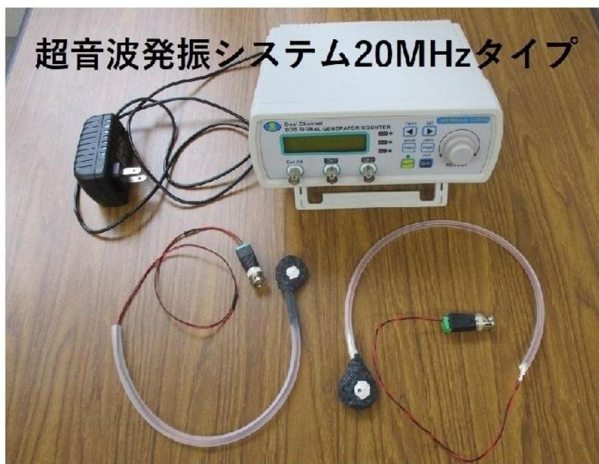
システム概要 (超音波発振システム (20MHz))
