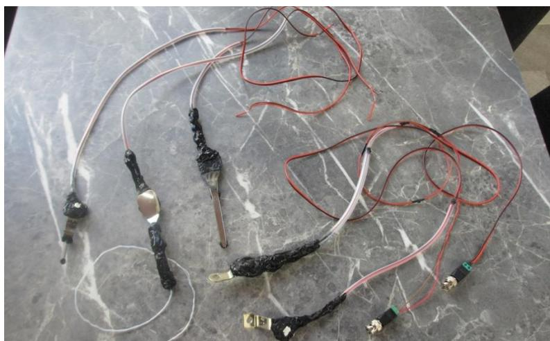
超音波素子の新しい固定方法による超音波プローブ
