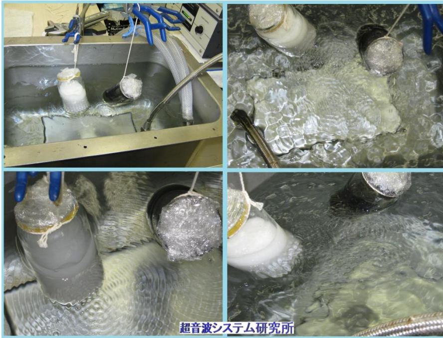
超音波により激しく動く液面（高周波の例） 図15
