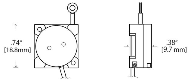
M150は世界最小のワイヤ伸長式変位センサです。親指サイズで18.8×18.8×9.7mmのほんの小さなスペースしか場所を取らず、最大で38.1mmまで計測できます。このモデルは主に航空宇宙産業や自動車産業のスロットル位置検出やクラッシュテストの装置に使用されています。全てが頑丈なアルミニウム構造で、信頼性と素早く簡単な取付けの為に設計された極小モデルです。
